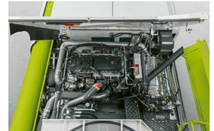
Mercedes-Benz OM 470 mit 300 kW / 408 PS für LEXION 6700
