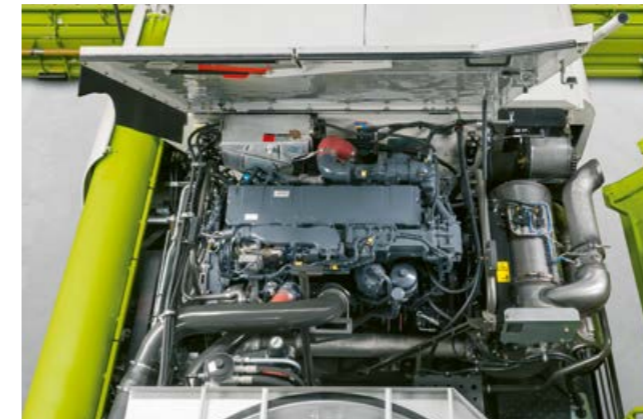
MAN D 26 mit 373 kW / 507 PS für LEXION 6900
