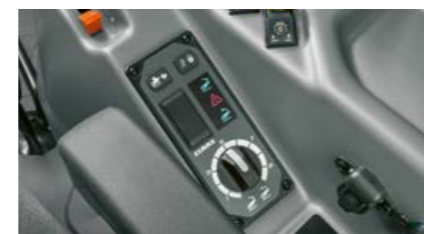
Sie haben die Wahl zwischen der elektronischen und der mechanischen Heckkraftheberregelung. Beide sind ergonomisch günstig rechts neben dem Fahrersitz platziert.
