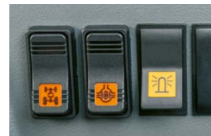
Elektronische Schaltung von Allrad- und Differentialsperre: Durch die geschwindigkeitsabhängige Sicherheitsabschaltung werden Fehlbedienungen vermieden.
