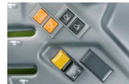
Zapfwellenarbeiten erledigen Sie mit dem ELIOS besonders einfach – dank des serienmäßigen Motordrehzahl Speichers.
