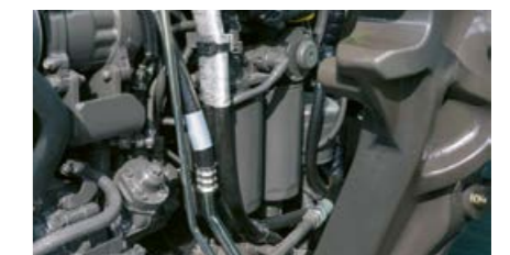
Die Ölfilter am Motor sind auch mit Frontladerkonsolen gut erreichbar.
