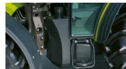
Das einfache Betanken mit Diesel ermöglicht der Einfüllstutzen am linken Kabineneinstieg.
