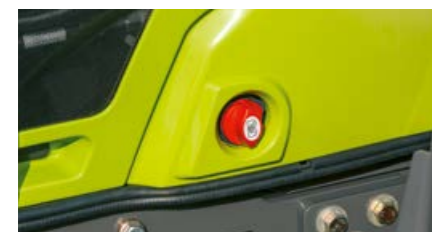
Der Batterietrennschalter ist leicht erreichbar in die Motorhaube integriert.
