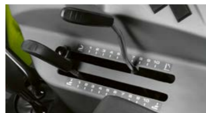
Sie haben die Wahl zwischen der elektronischen und der mechanischen Heckkraftheberregelung. Beide sind ergonomisch günstig rechts neben dem Fahrersitz platziert.
