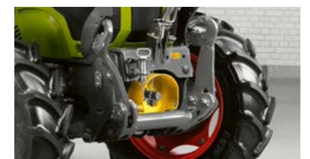
Der optionale Frontkraftheber mit 2,8 t Hubkraft und die Frontzapfwelle erweitern das Einsatzspektrum des ELIOS.
