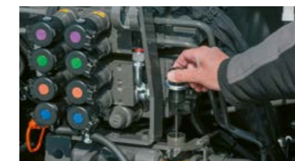
Der Stand des Getriebe- und Hydrauliköls wird mit einem Messstab am Heck kontrolliert.
