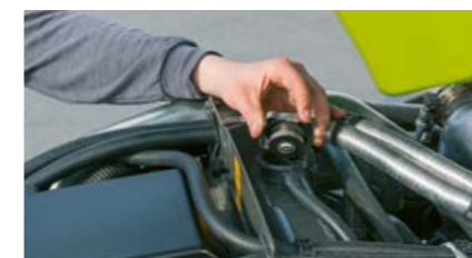
Der Kühlmittelstand kann am Ausgleichsbehälter des Kühlers überprüft werden.
