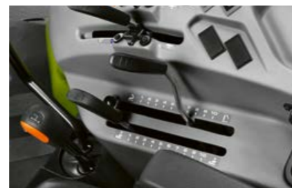
Mechanische Steuergeräte sind mit einer mechanischen oder elektronischen Heckkraftheberregelung auswählbar.
