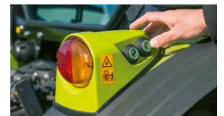
Sowohl der elektronische als auch der mechanische Heckkraftheber kann zum Geräteanbau extern am Heck bedient werden.
