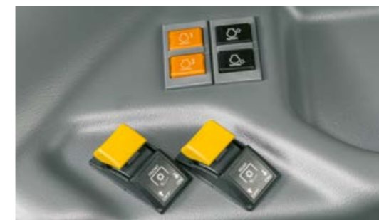
Die Frontzapfwelle wird immer elektronisch eingeschaltet. Für die Heckzapfwelle ist diese Funktion optional erhältlich.
